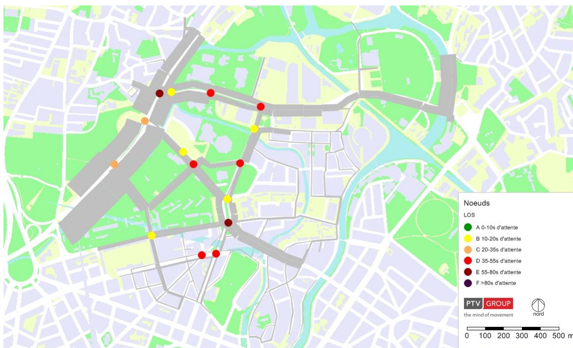
Fig. 26 : Temps d'attente moyens aux carrefours, long terme, nouveau barreau – Wenger Valentin - feux, HPM
