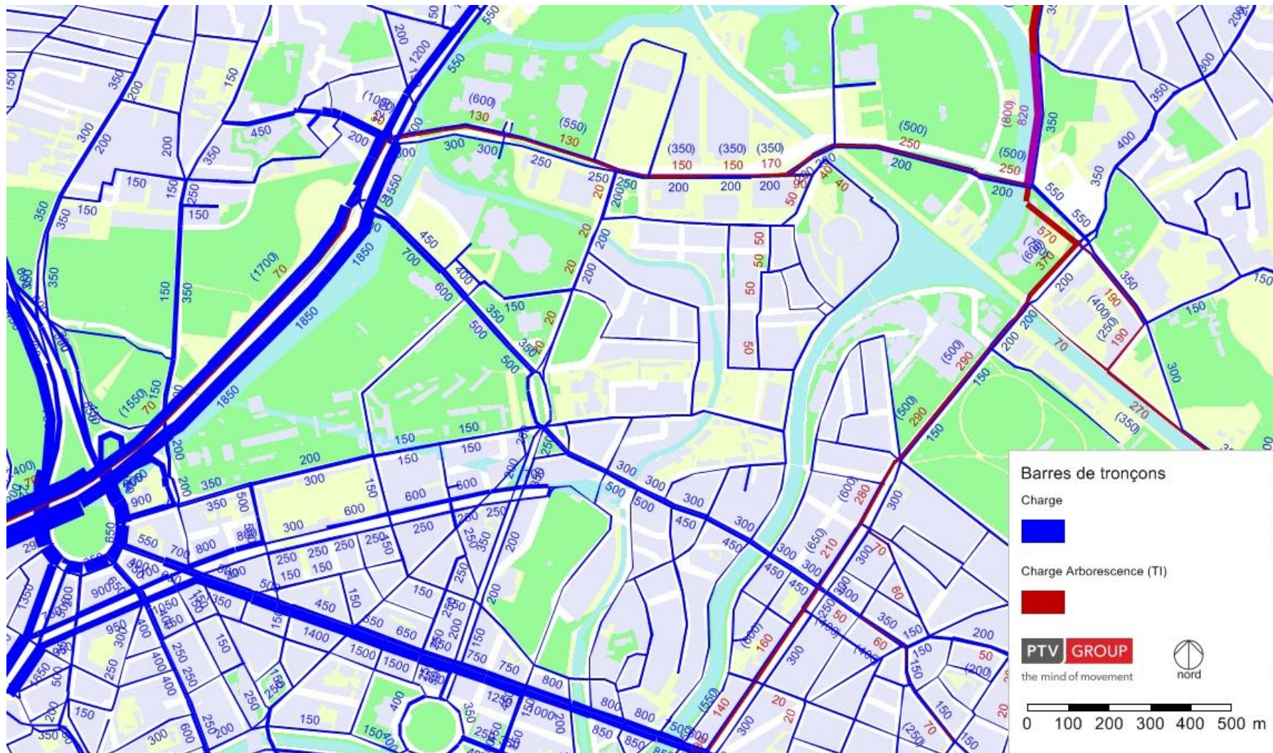
Fig. 69 : HPM, arborescence sur route de la wantzenau direction Wacken, situation actuelle
