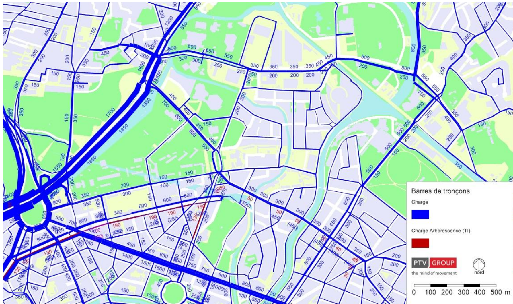
Fig. 72 : HPM, arborescence sur boulevard Clémenceau direction Wacken, situation actuelle
