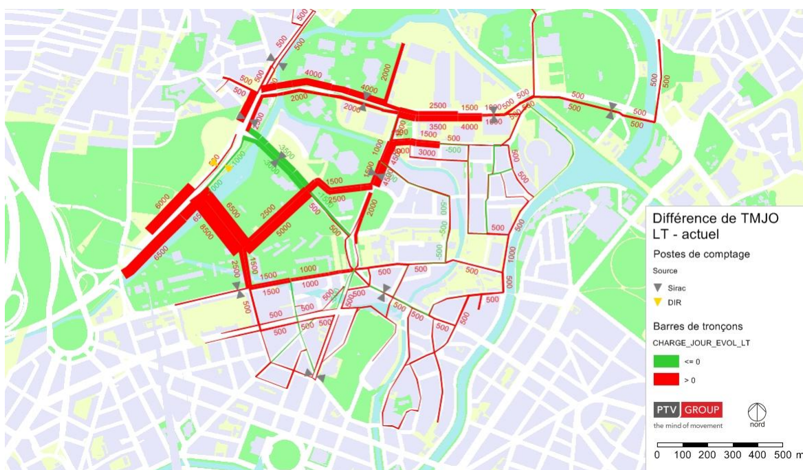
Fig. 31 : Différence de charges du réseau routier TMJO, long terme (nouveau barreau – Wenger Valentin – feux) - Actuel
