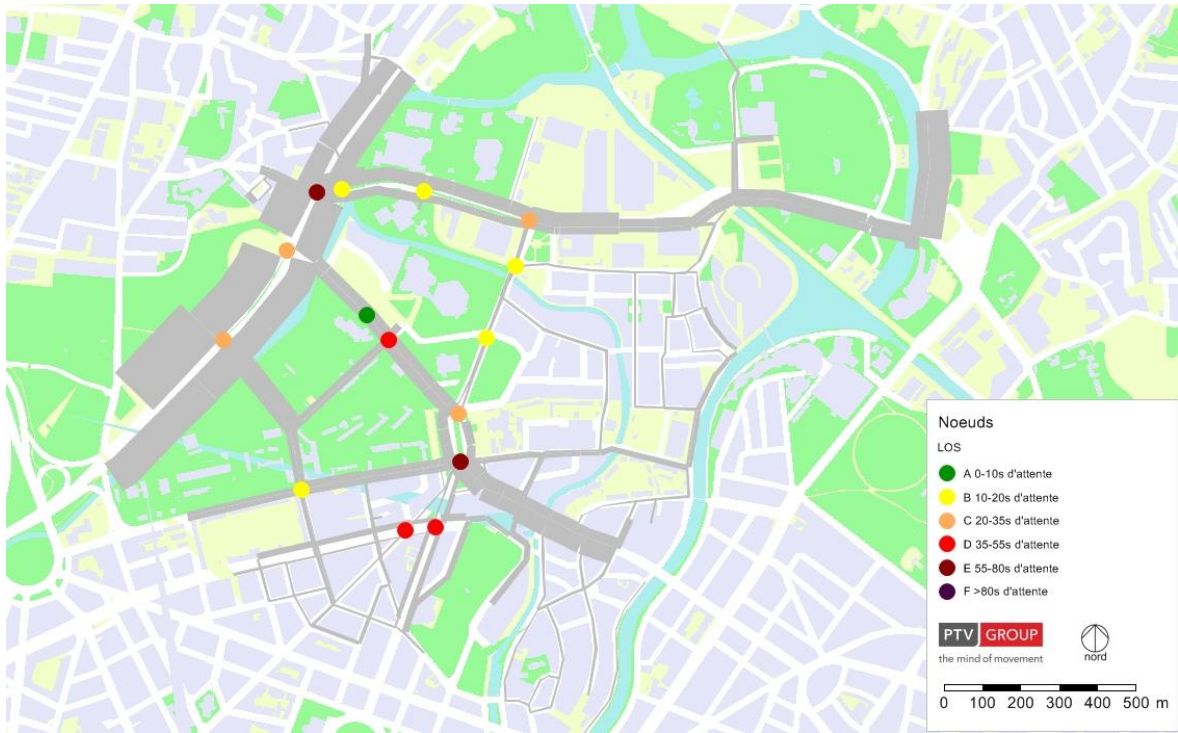
Fig. 53 : Temps d'attente moyens aux carrefours, moyen terme, nouveau barreau, sans Strauss, HPS
