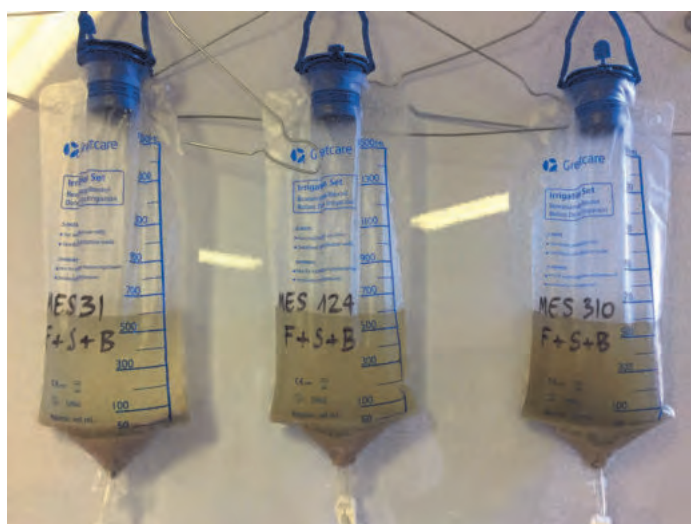
Figure 8 : Réalisation des tests de filtration des eaux usées contenant une teneur en MES connue (31, 124 et 310 mg/L). Filtration sur lit de bille + sable de Fontainebleau + EWS Aquasystem. (Source IRES)
