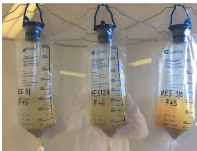
Figure 7 : Réalisation des tests de filtration des eaux usées contenant une teneur en MES connue (31, 124 et 310 mg/L). Filtration sur sable de Fontainebleau + EWS Aquasystem. (Source IRES)
