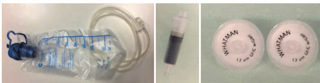
Figure 3 : Dispositif de prélèvement EWS Aquasystem. Poche avec tuyau d'écoulement et bague d'arrêt de l'écoulement, Cartouche contenant la phase adsorbante et Filtre pour la collecte des MES. (Source IRES)
