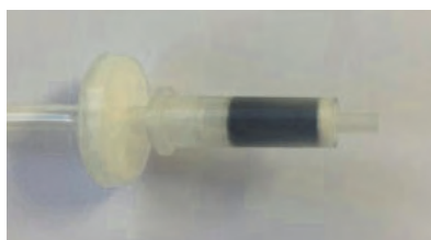
Figure 4 : Montage de la partie filtrante : Filtre pour la collecte des MES en amont de la cartouche contenant la phase adsorbante. (Source IRES)
