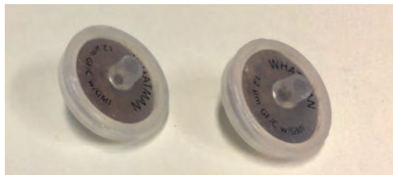
Figure 5 : Dépôt des MES sur les filtres de porosité 1,2 \mu\text{m} . (Source IRES)
