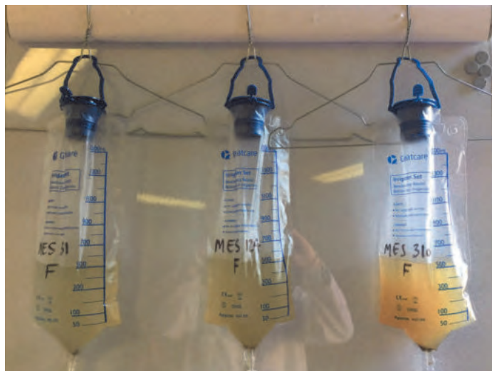
Figure 6 : Réalisation des tests de filtration des eaux usées contenant une teneur en MES connue (31, 124 et 310 mg/L). Filtration sur EWS Aquasystem. (Source IRES)
