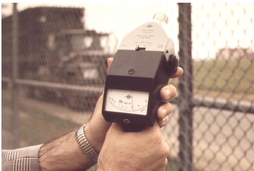
**ILLUSTRATION 14 MESURE DU NIVEAU DE BRUIT À PROXIMITÉ D'UNE ROUTE À L'AIDE D'UN SONOMÈTRE (SOURCE: WIKIPEDIA)**
