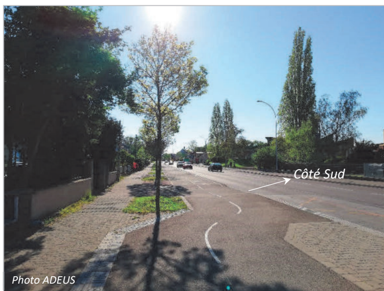
Exemple d'aménagement ne permettant pas un ombrage optimal des déplacements doux (axe routier structurant orienté Est-Ouest). La piste cyclable, au Sud des arbres, ne bénéficie pas de l'ombrage apporté par ces derniers
