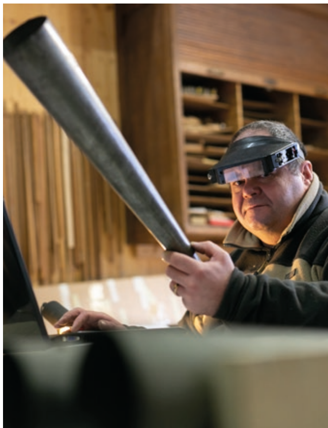
La manufacture Muhleisen conçoit et assure l'entretien d'orgues. Ici, un tuyau de l'orgue de la cathédrale de Versailles.
