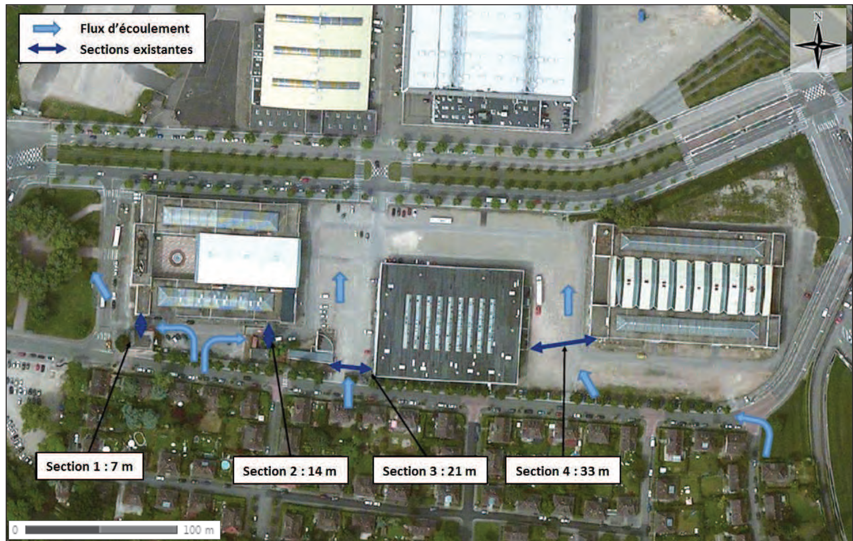
Fig. 51. Sections hydrauliques situation actuelle
